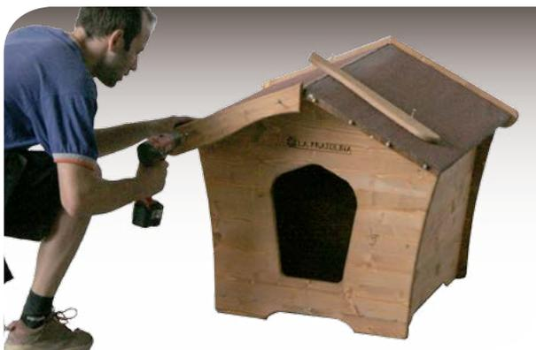
Unite le cornici alle falde del tetto dopo aver inserito in quest'ultime le spine di legno. Fissate poi con le viti 5x50.
