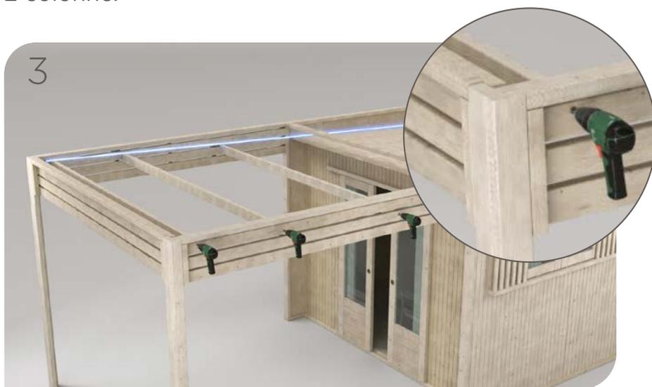
Fissare i travetti della tettoia, mantenendo lo stesso allineamento del tetto della casetta
