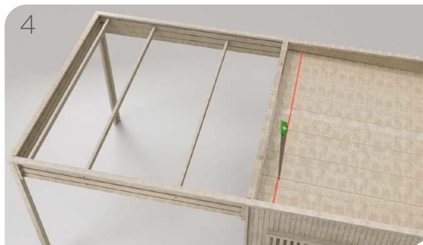
Accorciare le perline del tetto della casetta per giuntarle a quelle della tettoia sopra la parete frontale.
