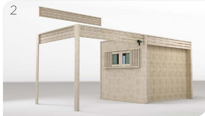
Fissaggio del fianco della tettoia alla casetta tramite gli elementi frontali e posteriori della tettoia.
