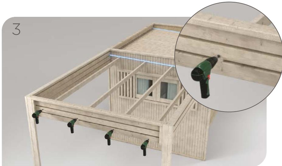
Fissare i travetti della tettoia, mantenendo lo stesso allineamento del tetto della casetta.
